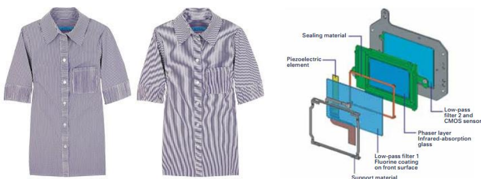
Obr. 6 vlevo – vada moiré u proužkované košile [7], vpravo – sada filtrů před obrazovým senzorem + čistící mechanismus [8]
